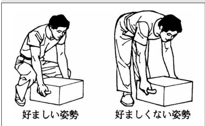
図2 重量物取扱作業の作業姿勢図
